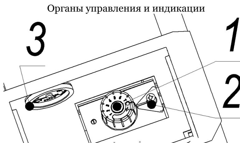
1 - ручка регулятора температуры; 2 - кнопка пьезорозжига; 3 - индикатор температуры.
